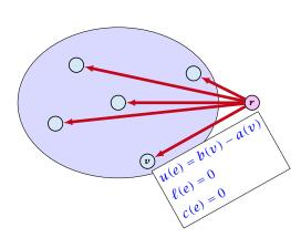
$$\begin{aligned} & \min \quad \sum_{e} c(e) f(e) \\ & \text{s.t.} \quad \forall e \in E: \ \ell(e) \leq f(e) \leq u(e) \\ & \quad \forall v \in V: \ a(v) \leq f(v) \leq b(v) \end{aligned}$$
